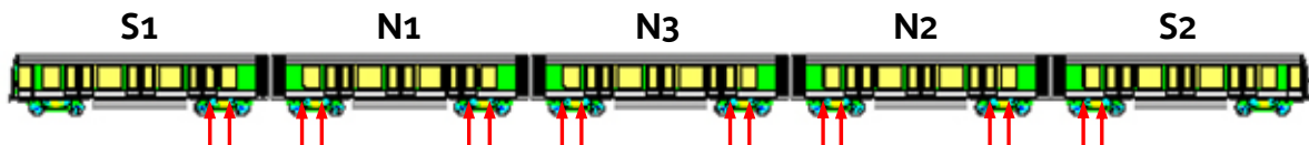
Implantation des tirettes d'isolement des FI
