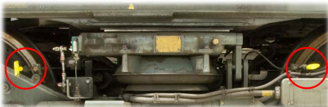
Implantation des tirettes d'isolement des FI
