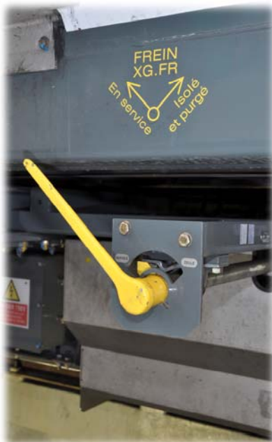
XG.FR ouvert (en service) avec clé de manœuvre en place
