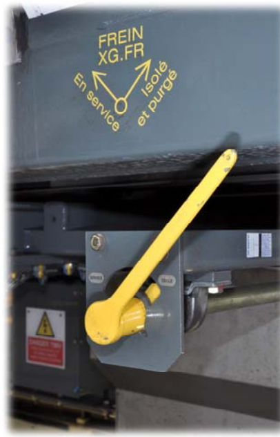
XG.FR fermé (isolé et purgé) avec clé de manœuvre en place
